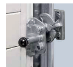
Verrou à pêne tournant Ce verrouillage de porte s'enclenche automatiquement par disque autobloquant.
